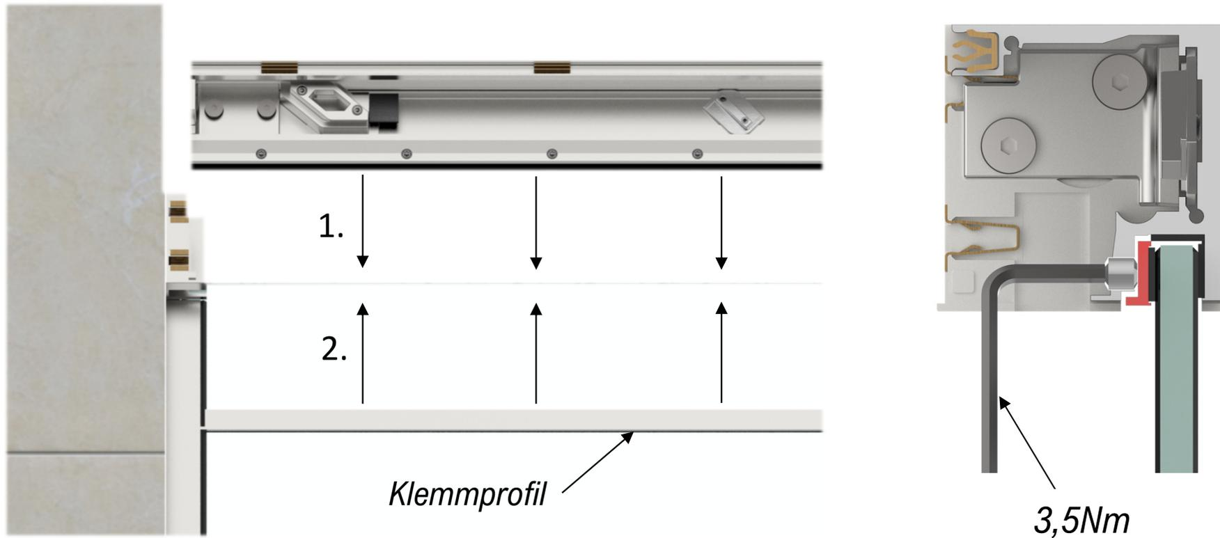
1. Laufschiene auf Seitenteil aufsetzen
